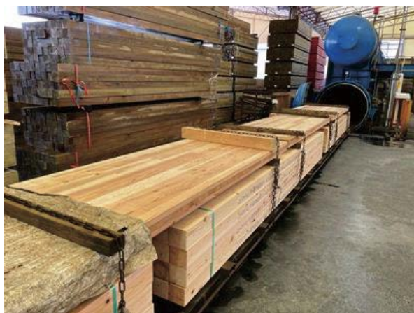
図 2. 2. 3. 3-1 注入風景（最上段が CLT 実大パネル試験体）
