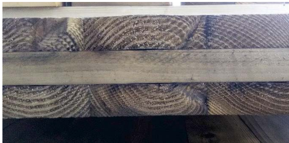
人工乾燥後のはく離（接着層・幅はぎ部の隙間）
