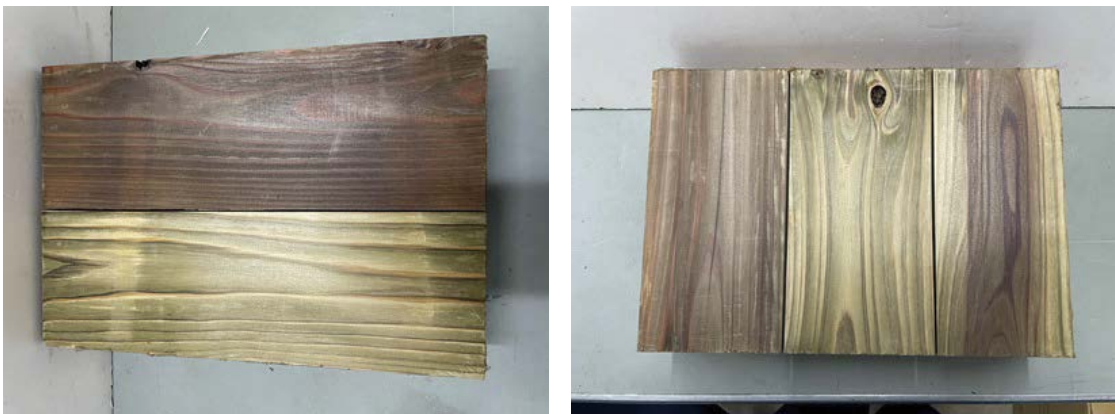
図 2.2.2.3-5 乾燥後の試験材の幅はぎ部分の隙間の様子 （左：強軸方向試験体、右：弱軸方向試験体）
