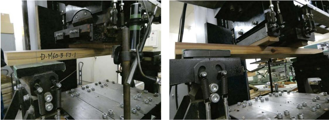
写真 2.3.3.1.2-1~2 FJ ラミナのフラットワイズ曲げ試験の様子
