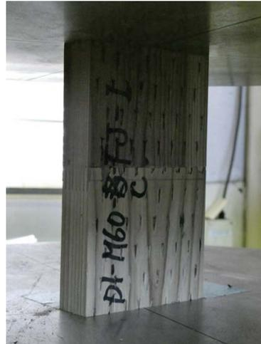
写真 2.3.3.1.3-1～2 FJラミナの縦圧縮試験の様子
