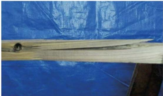
写真 2.3.3.1.2-7~8 インサイジングあり外層用の破壊形態の例 (No. 18) 繊維傾斜+FJによる破壊
