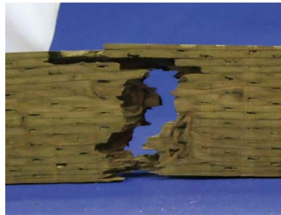
写真 2.3.3.1.4-9~10 インサイジングあり内層用の破壊形態の例
