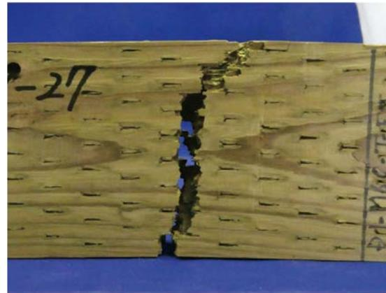
写真 2.3.3.1.4-7~8 インサイジングあり外層用の破壊形態の例
