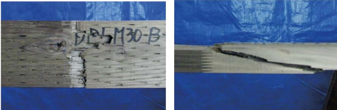
写真 2.3.3.1.2-11~12 インサイジングあり内層用の破壊形態の例 (No.14) FJ+繊維傾斜+節による破壊
