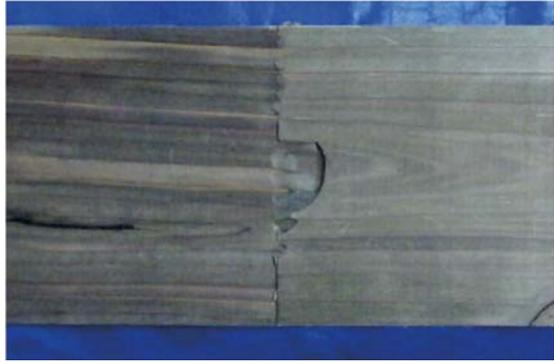
写真 2.3.3.1.2-5~6 インサイジングなし内層用の破壊形態の例 (No. 15) FJ+欠けによる破壊
