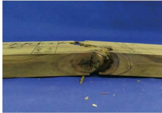
写真 2.3.3.1.4-5~6 インサイジングなし内層用の破壊形態の例
