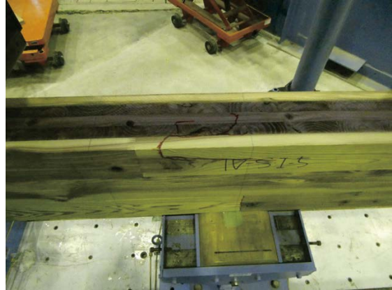
写真 2.3.3.2.5-5~6 インサイジングなしのせん断+曲げ破壊の例 (IV-SI-5)
