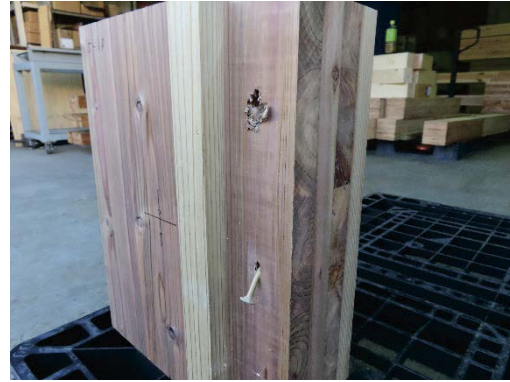
写真 2.3.4-3 タッピングねじの引き抜けとパンチング
