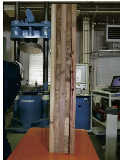
写真 2.3.3.2.3-3~4 インサイジングなしの破壊例 (IV-C-2)
