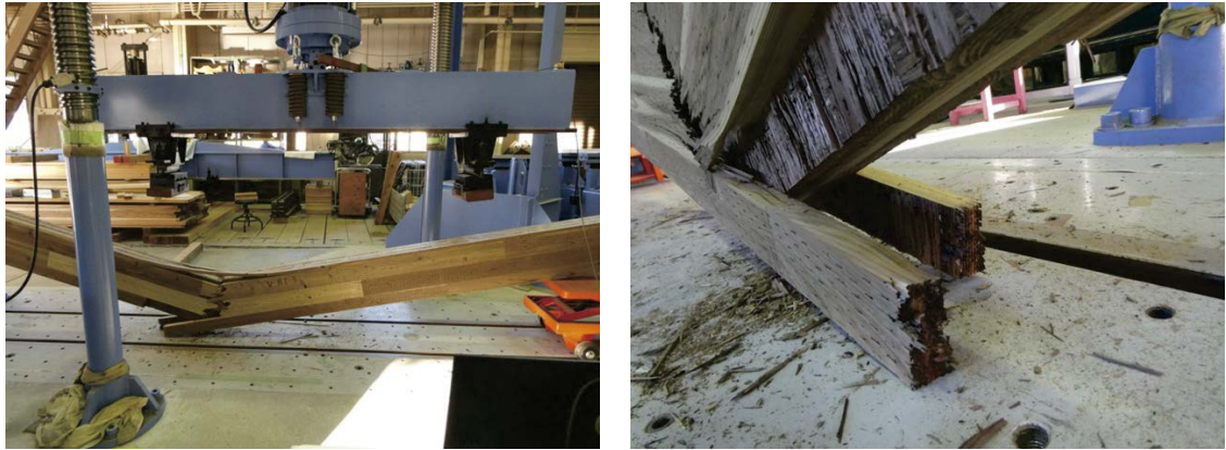
写真 2.3.3.2.2-9~10 インサイジングありの破壊例 (V-BI-3)
