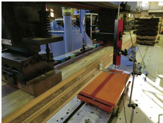
写真 2.3.3.2.1-1～2 曲げ・積層方向試験の様子
