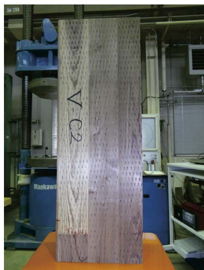
写真 2.3.3.2.3-7~8 インサイジングありの破壊例 (V-C-2)
