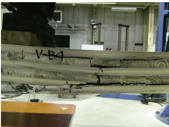
写真 2.3.3.2.1-7~8 インサイジングありの破壊例 (V-B-4)
