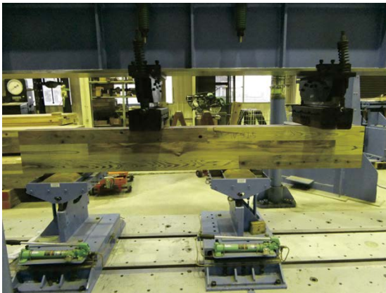
写真 2.3.3.2.5-5~6 インサイジングなしのせん断+曲げ破壊の例 (IV-SI-5)
