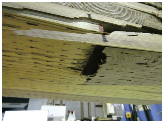
写真 2.3.3.2.1-7~8 インサイジングありの破壊例 (V-B-4)
