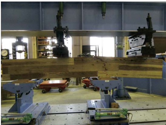
写真 2.3.3.2.5-9~10 インサイジングありの曲げ破壊の例 (V-SI-4)
