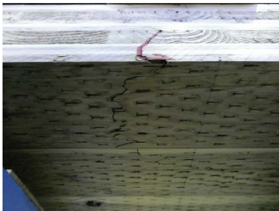
写真 2.3.3.2.4-9~10 インサイジングありの曲げ破壊の例 (V-S0-2)
