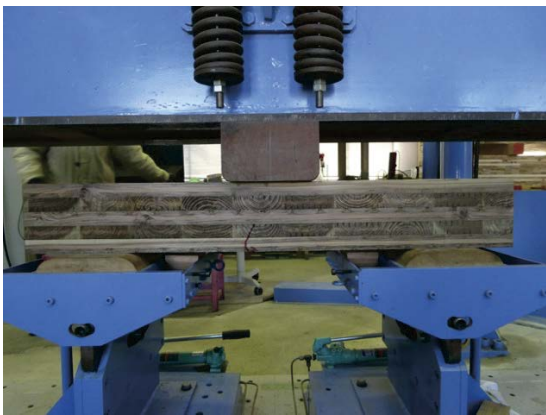
写真 2.3.3.2.4-9~10 インサイジングありの曲げ破壊の例 (V-S0-2)
