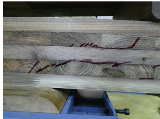
写真 2.3.3.2.4-3~4 インサイジングなしのせん断破壊の例 (IV-S0-1)
