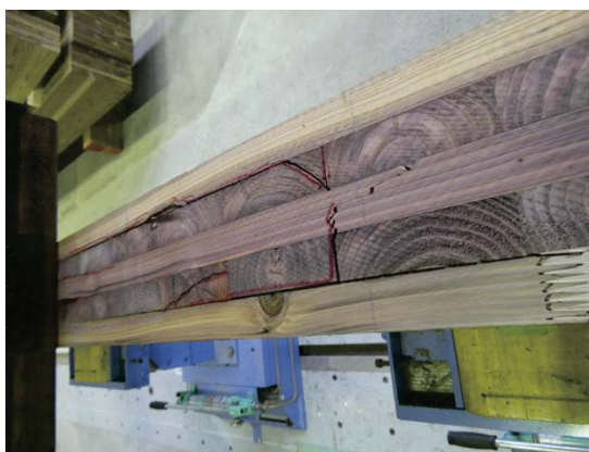
写真 2.3.3.2.5-3~4 インサイジングなしのせん断破壊の例 (IV-SI-1)
