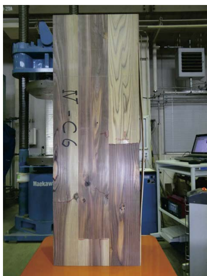
写真 2.3.3.2.3-5~6 インサイジングなしの破壊例 (IV-C-6)
