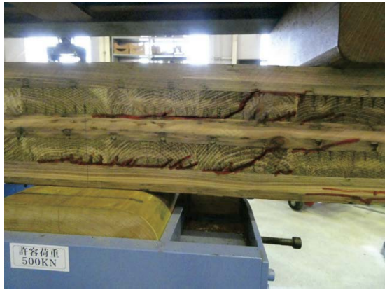
写真 2.3.3.2.4-7~8 インサイジングありのせん断破壊の例 (V-S0-1)
