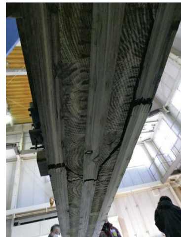
写真 2. 3. 3. 2. 2-7~8 インサイジングありの破壊例 (V-BI-1)
