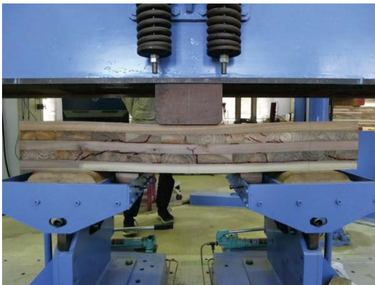
写真 2.3.3.2.4-3~4 インサイジングなしのせん断破壊の例 (IV-S0-1)
