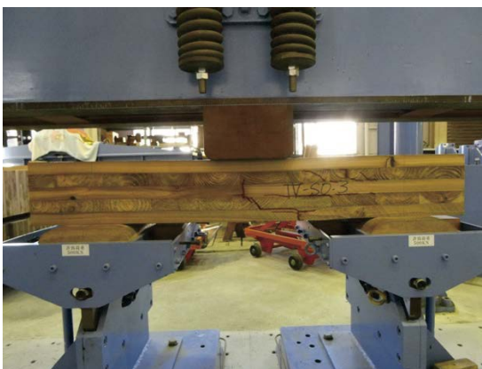
写真 2.3.3.2.4-5~6 インサイジングなしの曲げ破壊の例 (IV-S0-3)
