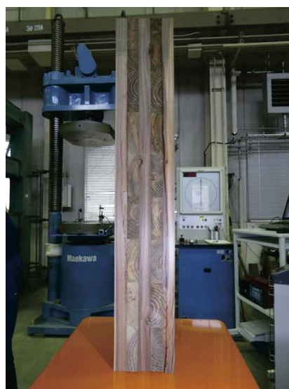
写真 2.3.3.2.3-5~6 インサイジングなしの破壊例 (IV-C-6)
