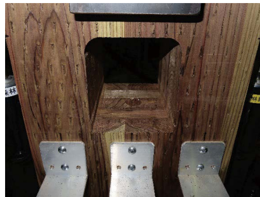
写真 2.3.4-14 加力後の貫通孔 (損傷はみられない)
