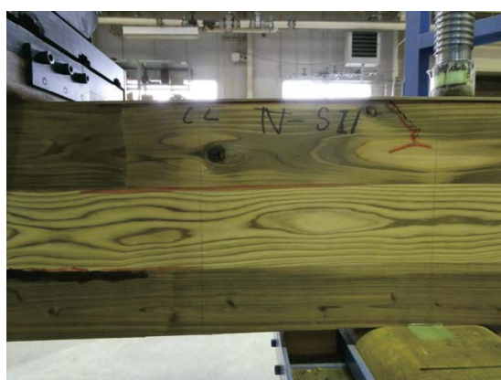
写真 2.3.3.2.5-3~4 インサイジングなしのせん断破壊の例 (IV-SI-1)
