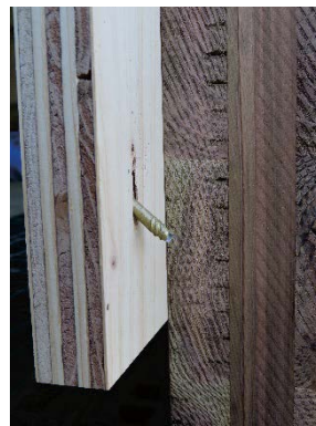
写真 2. 3. 4-7 タッピングねじの折損
