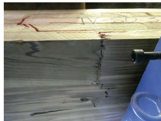
写真 2.3.3.2.4-5~6 インサイジングなしの曲げ破壊の例 (IV-S0-3)
