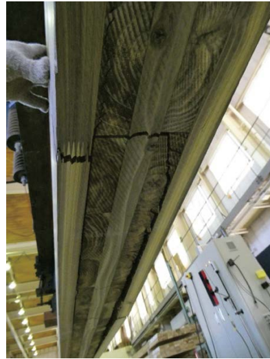
写真 2. 3. 3. 2. 2-3~4 インサイジングなしの破壊例 (IV-BI-1)
