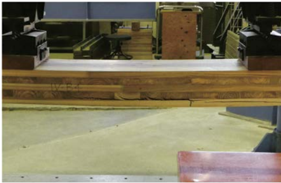
写真 2.3.3.2.1-3~4 インサイジングなしの破壊例 (IV-B-4)
