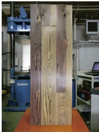
写真 2.3.3.2.3-3~4 インサイジングなしの破壊例 (IV-C-2)
