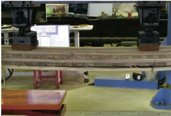
写真 2.3.3.2.1-5~6 インサイジングなしの破壊例 (IV-B-5)
