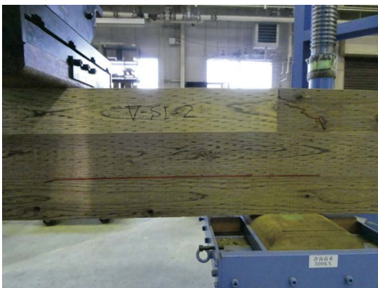
写真 2.3.3.2.5-7~8 インサイジングありのせん断+曲げ破壊の例 (V-SI-2)
