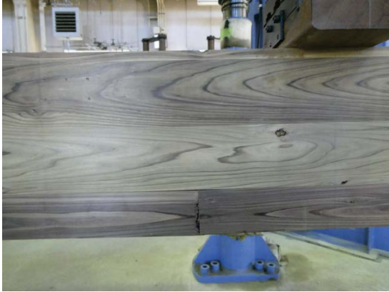
写真 2. 3. 3. 2. 2-3~4 インサイジングなしの破壊例 (IV-BI-1)
