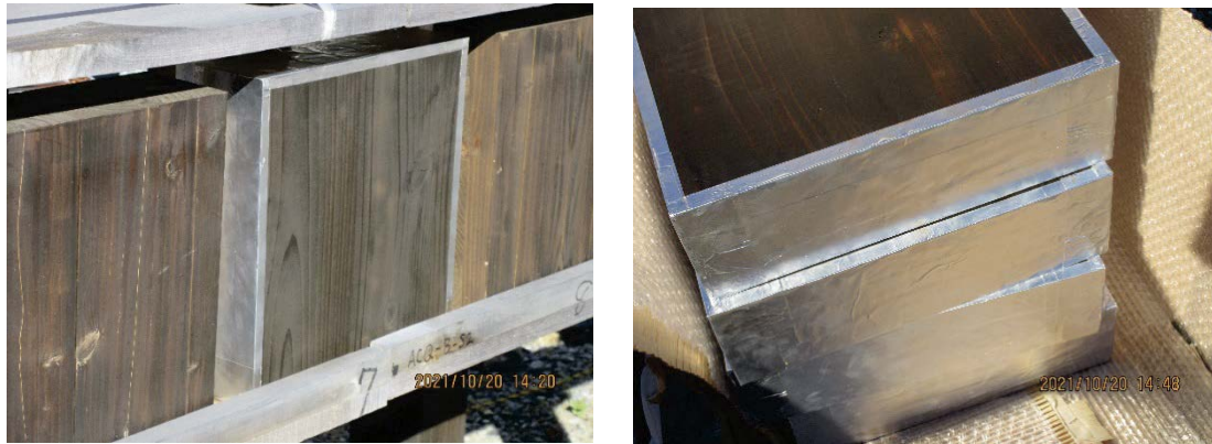
写真 4. 1. 2-2 木口シールした試験体の例
