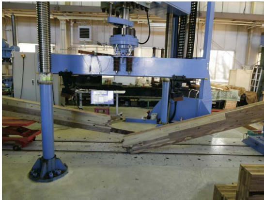
写真 2. 3. 3. 2. 2-5~6 インサイジングなしの破壊例 (IV-BI-2)
