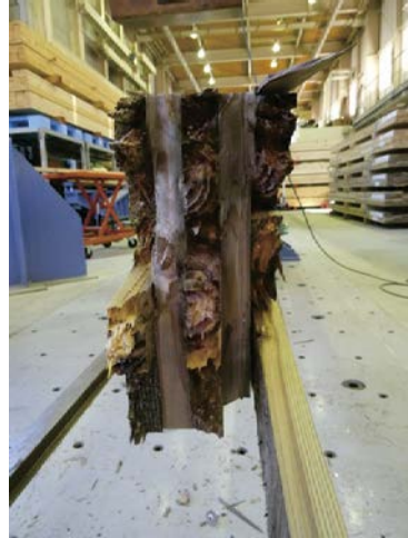
写真 2. 3. 3. 2. 2-5~6 インサイジングなしの破壊例 (IV-BI-2)
