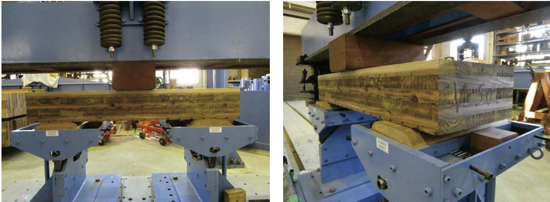
写真 2.3.3.2.4-1~2 セン断・積層方向試験の様子
