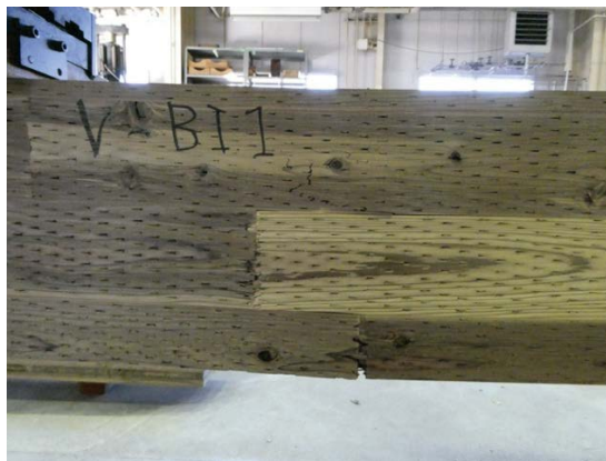
写真 2. 3. 3. 2. 2-7~8 インサイジングありの破壊例 (V-BI-1)
