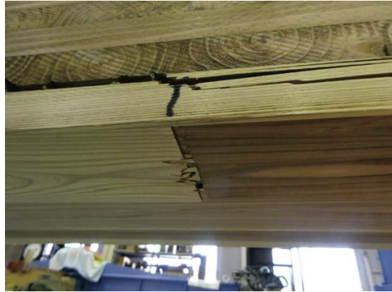
写真 2.3.3.2.1-3~4 インサイジングなしの破壊例 (IV-B-4)
