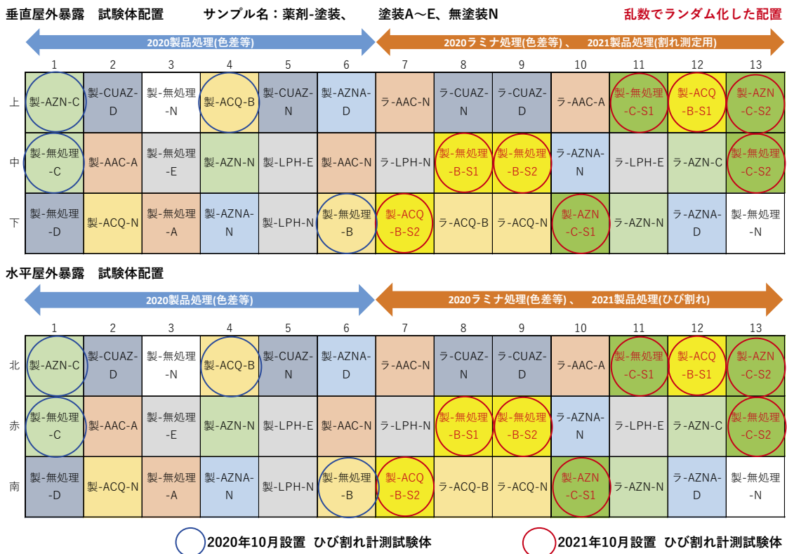
図 4. 2. 2-1 ひび割れ計測試験体の設置位置
