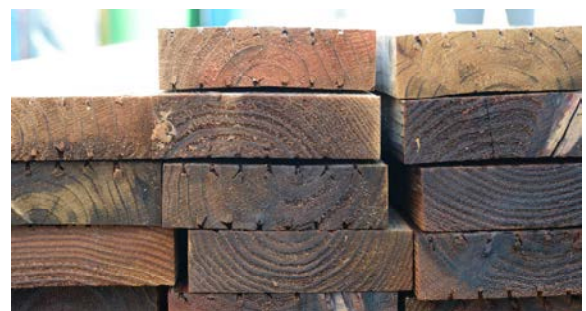
写真-1 加圧注入後のラミナ (ラミナ注入)
