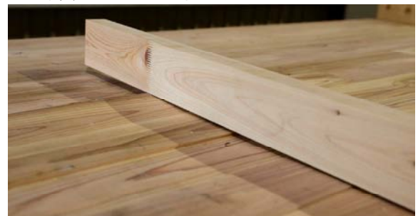
写真-2 加圧注入後のCLT (製品注入)
