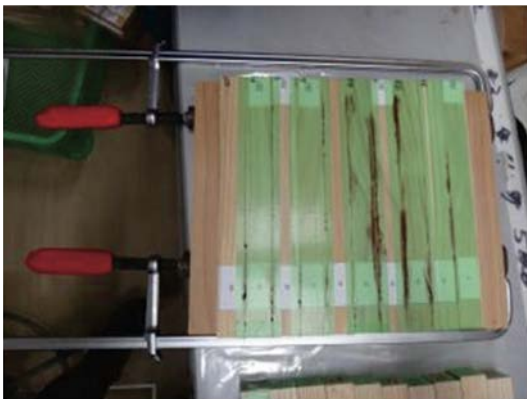
写真5-1 試験材10本を幅はぎ接着
