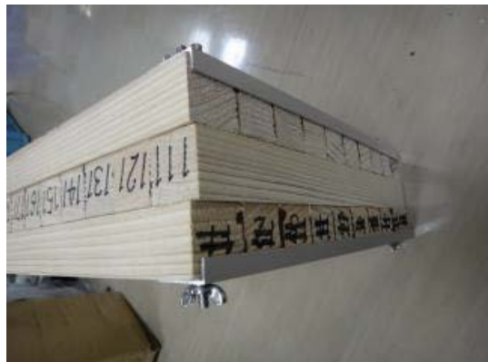
写真5-2 幅はぎ層3層を直交積層して固定
