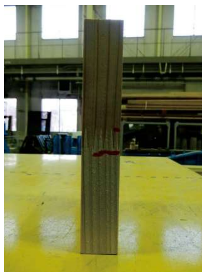
写真 2. 3. 8. 3-4 無処理 M30 の破壊形態の例
