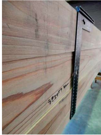
写真 2.3.1-5 接着層のはがれ (12-T) 写真 2.3.1-6 はがれによる浮き上がり 5mm (12-T)
