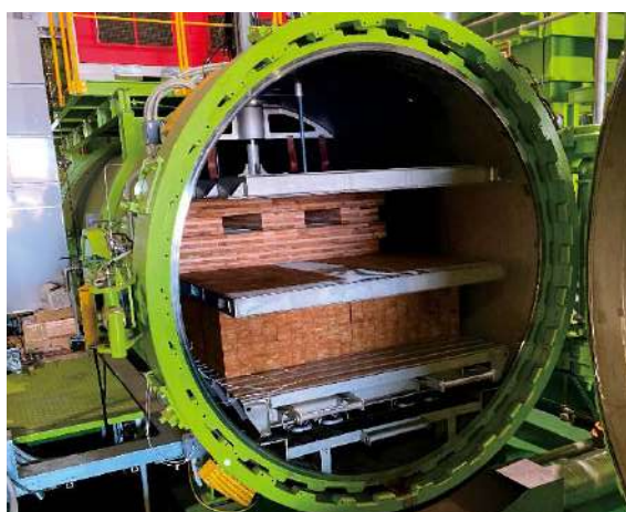
写真 2.2.4-1 注入時の様子
