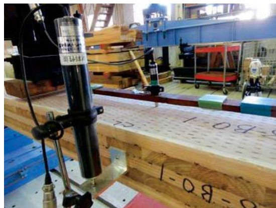
写真 2.3.2-2 曲げ・積層方向試験の様子
