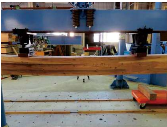
写真 2. 3. 3-11~12 接着層のはがれが存在した製品処理 AZN の破壊 (12-BI-1)
