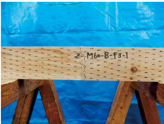
写真 2. 3. 8. 2-7 AAC 処理 M60 の破壊形態の例
