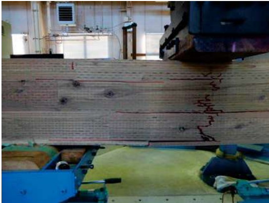
写真 2.3.7-9~10 ラミナ処理 ACQ (5-SI-1) のせん断+曲げ破壊の例
