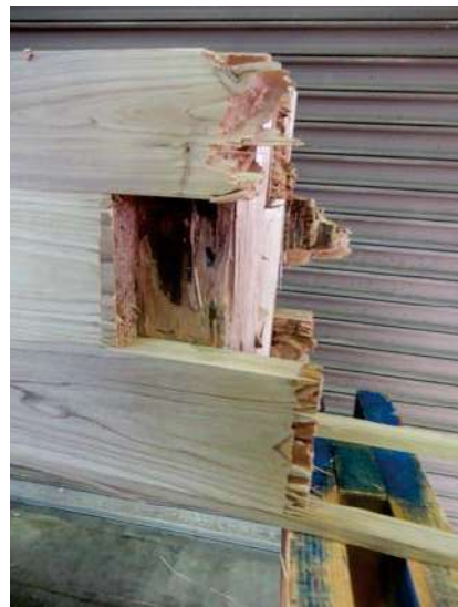
写真 2. 3. 5-9~10 製品処理 AZN の破壊例 (11-T)
