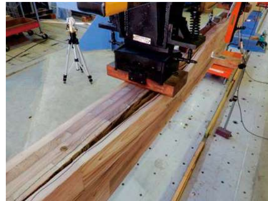
写真 2. 3. 3-11~12 接着層のはがれが存在した製品処理 AZN の破壊 (12-BI-1)
