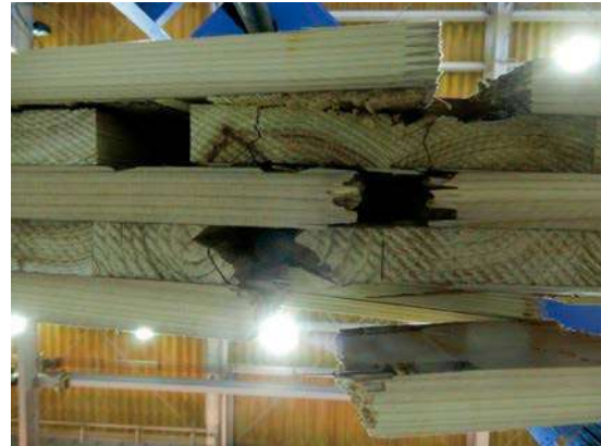
写真 2. 3. 3-9 製品処理 AZN の破壊例 (10-BI-1) 写真 2. 3. 3-10 製品処理 AZN の破壊例 (10-BI-1)
