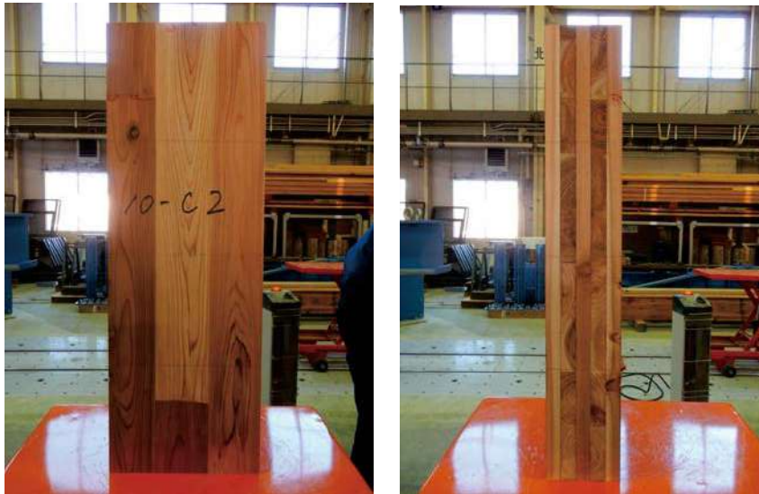
写真 2. 3. 4-9~10 製品処理 AZN の破壊例 (10-C-2)
