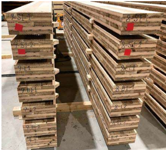
写真2.2.1-7 試験体切り出し加工後のCLT (左:曲げ・引張り等, 右:余り) (写真提供:スナダヤ)
