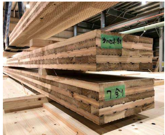
写真2.2.1-7 試験体切り出し加工後のCLT (左:曲げ・引張り等, 右:余り) (写真提供:スナダヤ)
