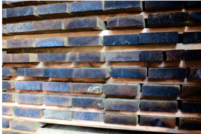
写真2. 2. 1-3 加圧注入後再乾燥前のラミナ (ACQ)
