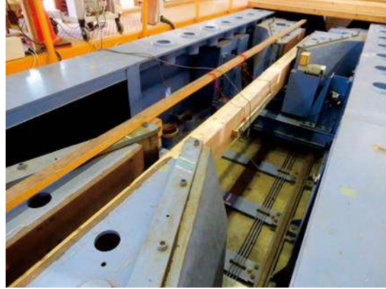
写真 2.3.5-2 引張試験の様子
