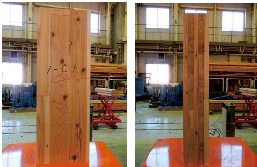
写真 2.3.4-3~4 無処理の破壊例 (1-C-1)
