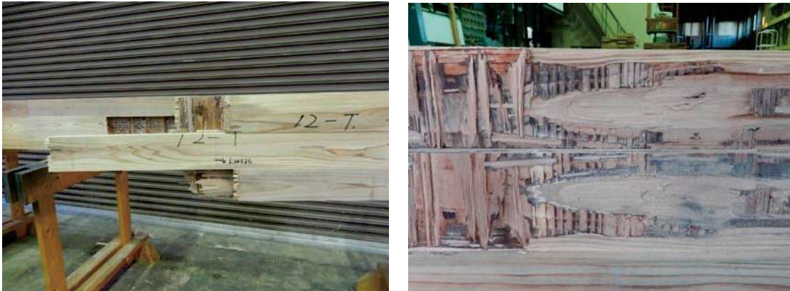
写真 2.3.4-11~12 製品処理 AZN の破壊例 (12-T)
