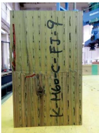
写真 2. 3. 8. 3-5 ACQ 処理 M60 の破壊形態の例
