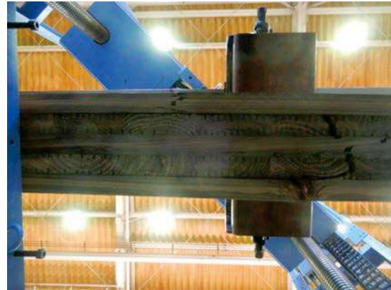
写真 2.3.7-9~10 ラミナ処理 ACQ (5-SI-1) のせん断+曲げ破壊の例
