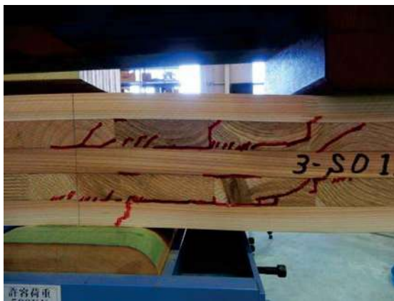
写真 2.3.6-3 無処理のせん断破壊例 (3-S0-1)
