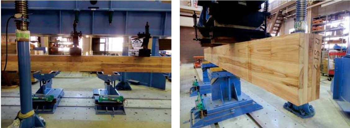
写真 2.3.7-1～2 せん断・幅方向試験の様子
