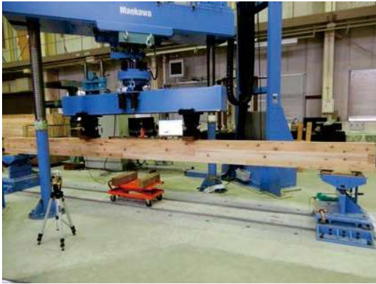
写真 2.3.3-1 曲げ・幅方向試験の様子
