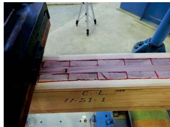
写真 2.3.7-13~14 製品処理 AZN のせん断破壊の例 (11-SI-1)
