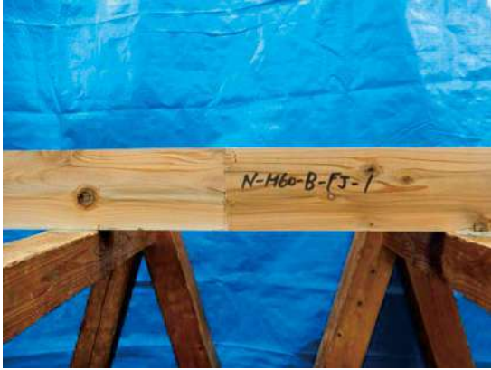
写真 2. 3. 8. 2-3 無処理 M60 の破壊形態の例
