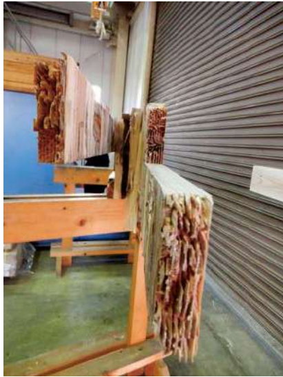
写真 2.3.5-3~4 無処理の破壊例 (1-T)
