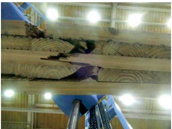
写真 2.3.3-8 ラミナ処理 AAC の破壊例 (7-BI-1)
