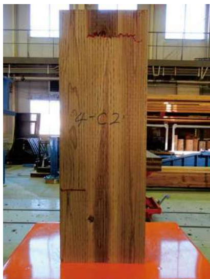
写真 2. 3. 4-5~6 ラミナ処理 ACQ の破壊例 (4-C-2)
