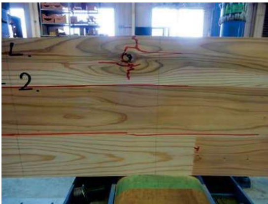
写真 2. 3. 7-5~6 無処理のせん断破壊の例 (1-SI-2)
