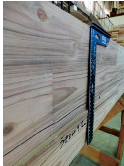
写真 2.3.1-7 接着層のはがれ (12-BI-1) 写真 2.3.1-8 はがれによる浮き上がり 7mm (12-BI-1)
