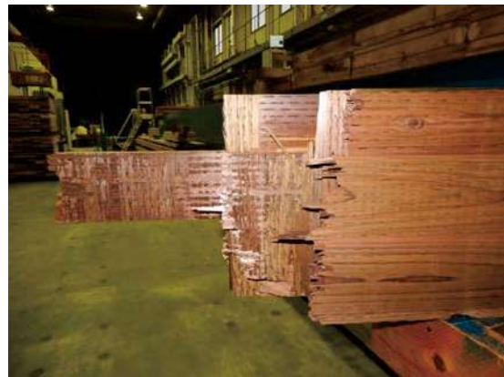
写真 2.3.5-5~6 ラミナ処理 ACQ の破壊例 (4-T)
