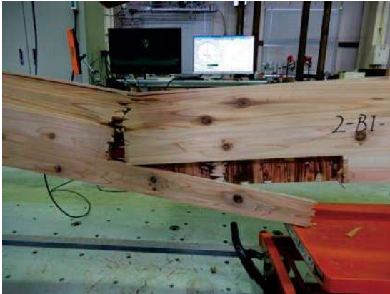
写真 2.3.3-3 無処理の破壊例 (2-BI-1)
