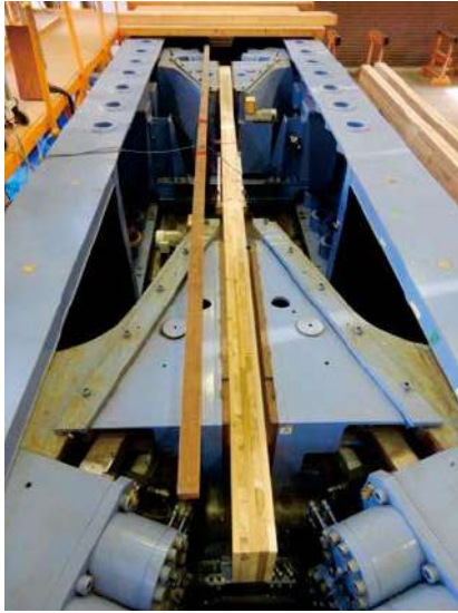
写真 2.3.5-1 引張試験の様子
