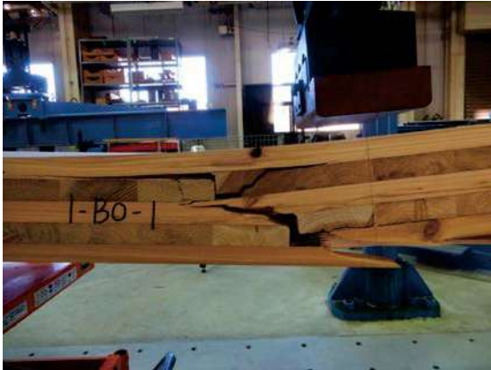
写真 2.3.2-3 無処理の破壊例 (1-B0-1)
