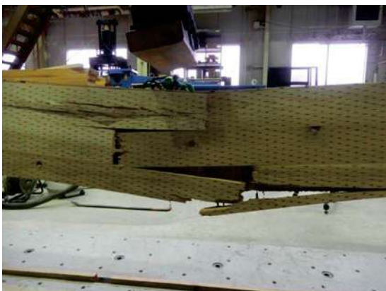
写真 2.3.3-7 ラミナ処理 AAC の破壊例 (7-BI-1)
