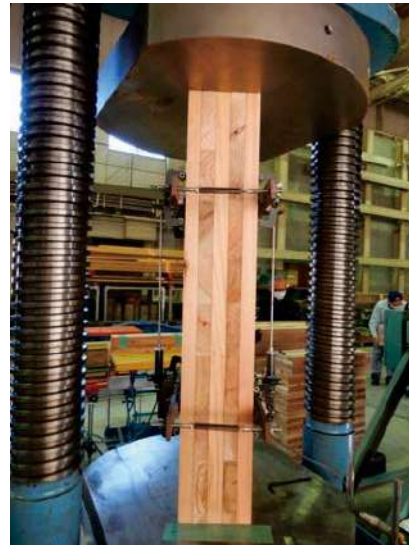
写真 2.3.4-2 圧縮試験の様子
