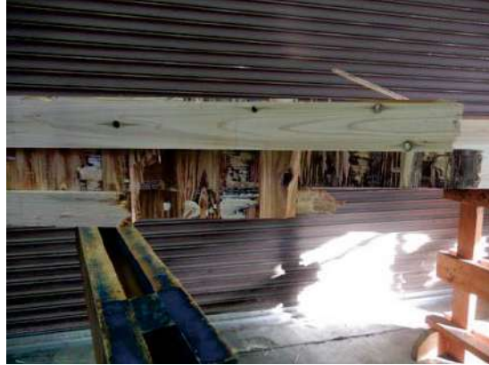
写真 2.3.5-3~4 無処理の破壊例 (1-T)
