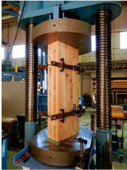
写真 2.3.4-1 圧縮試験の様子
