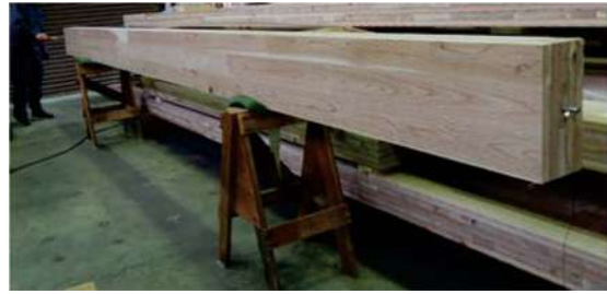
写真 2.3.1-10 縦振動法による共振周波数測定の様子
