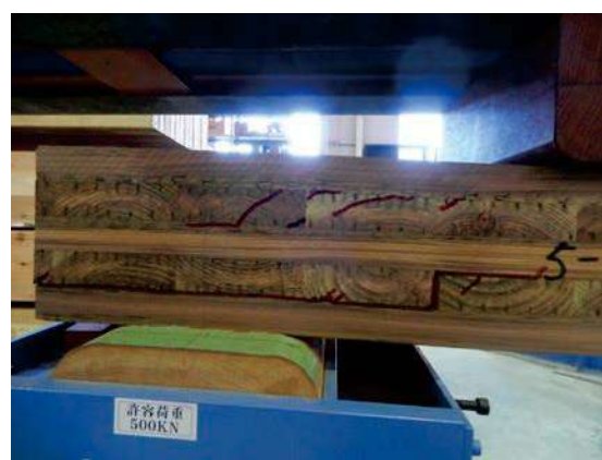
写真 2.3.6-4 ラミナ処理 ACQ のせん断破壊例 (5-S0-1)
