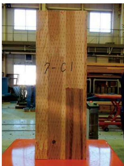
写真 2. 3. 4-7~8 ラミナ処理 AAC の破壊例 (7-C-1)
