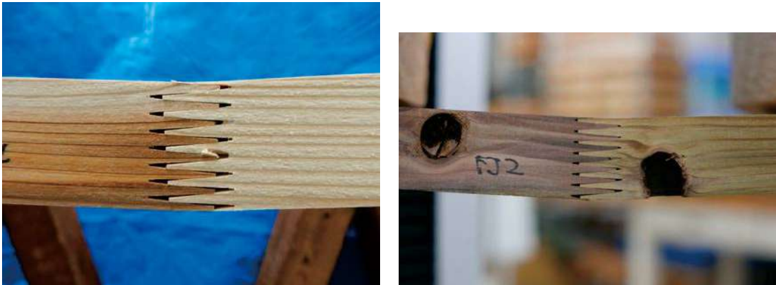
写真 2.3.8.2-9 無処理 M60 の FJ 抜けした試験体 写真 2.3.8.2-10 ACQ 処理 M60 の FJ 抜けした試験体
