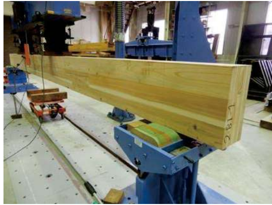
写真 2.3.3-2 曲げ・幅方向試験の様子
