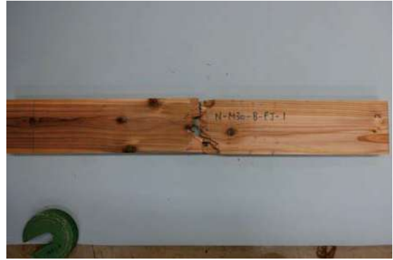
写真 2. 3. 8. 2-4 無処理 M30 の破壊形態の例
