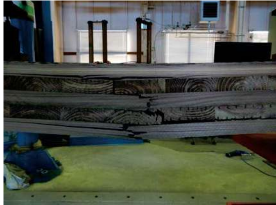
写真 2.3.2-4 ラミナ処理 ACQ の破壊例 (6-B0-2)
