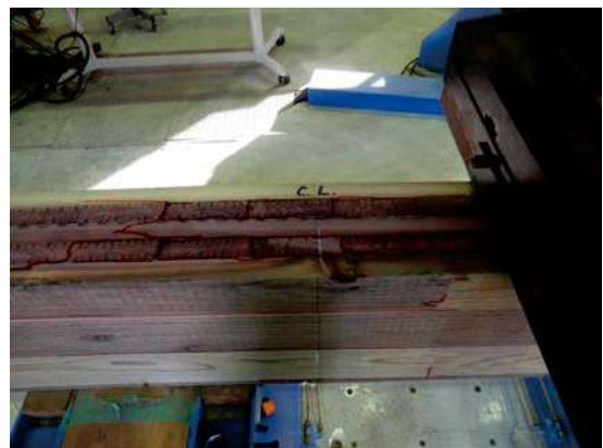
写真 2. 3. 7-7~8 ラミナ処理 ACQ のせん断破壊の例 (4-SI-1)
