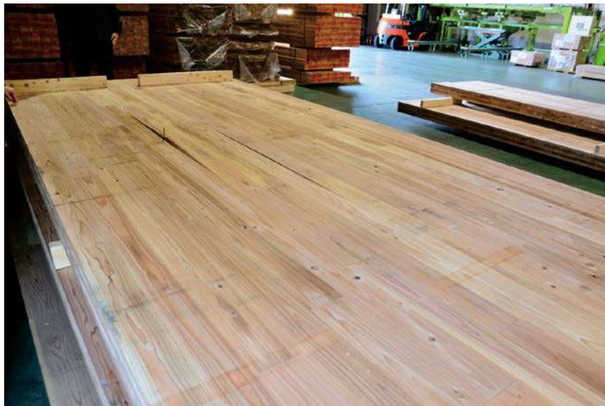
写真2. 2. 1-4 製品注入後のCLT-外層の浮きが認められる (AZN-No. 12)
