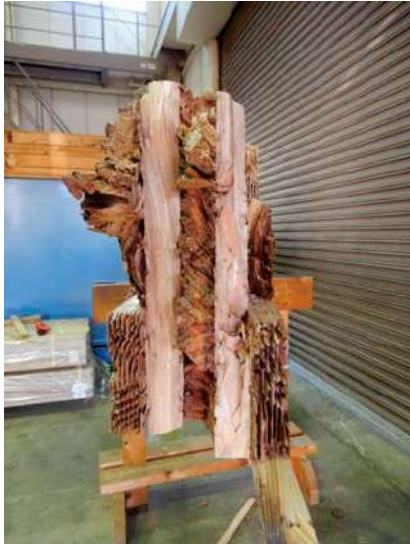
写真 2. 3. 5-7~8 ラミナ処理 AAC の破壊例 (8-T)
