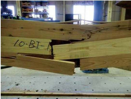
写真 2. 3. 3-9 製品処理 AZN の破壊例 (10-BI-1) 写真 2. 3. 3-10 製品処理 AZN の破壊例 (10-BI-1)
