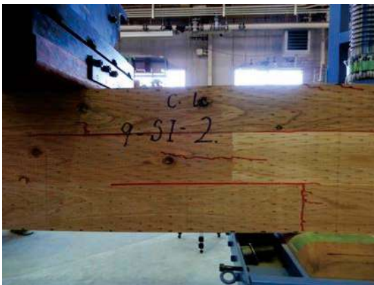
写真 2.3.7-11~12 ラミナ処理 AAC のせん断破壊の例 (9-SI-2)
