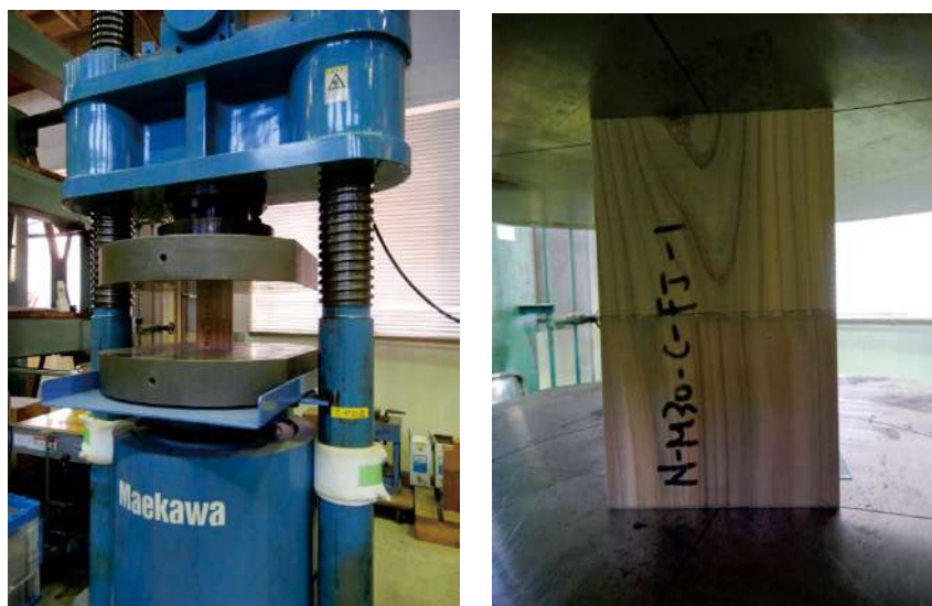
写真 2.3.8.3-1～2 FJ ラミナの縦圧縮試験の様子
