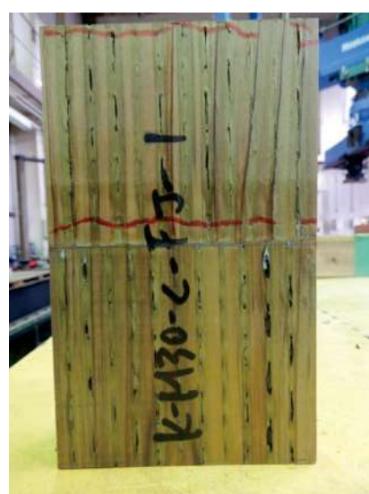
写真 2. 3. 8. 3-6 ACQ 処理 M30 の破壊形態の例
