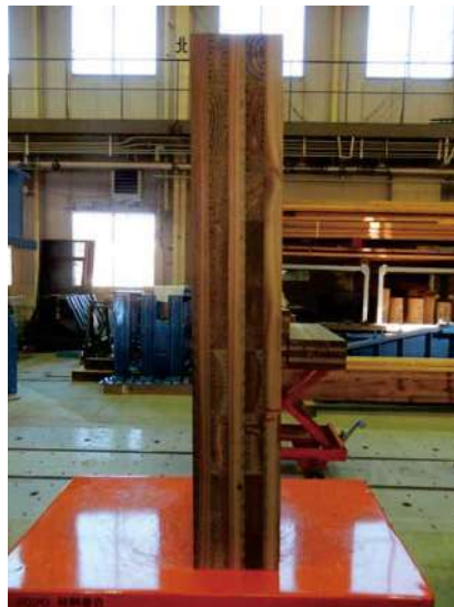
写真 2. 3. 4-5~6 ラミナ処理 ACQ の破壊例 (4-C-2)
