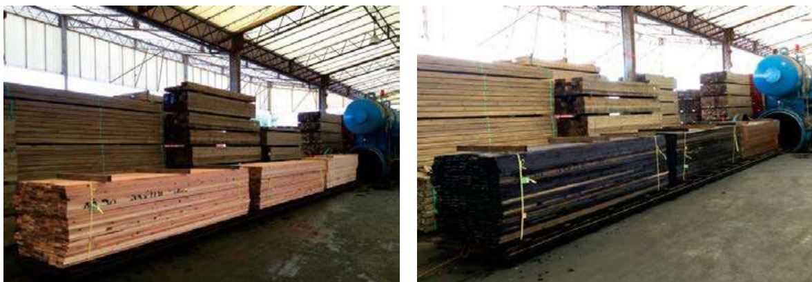
写真 2.2.2-1 注入前後の様子（左：注入前、右：注入後）
