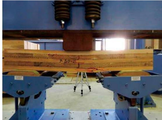
写真 2.3.6-6 ラミナ処理 AAC の曲げ破壊例 (9-S0-2)
