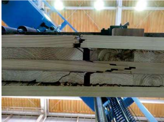
写真 2.3.3-4 無処理の破壊例 (3-BI-1)
