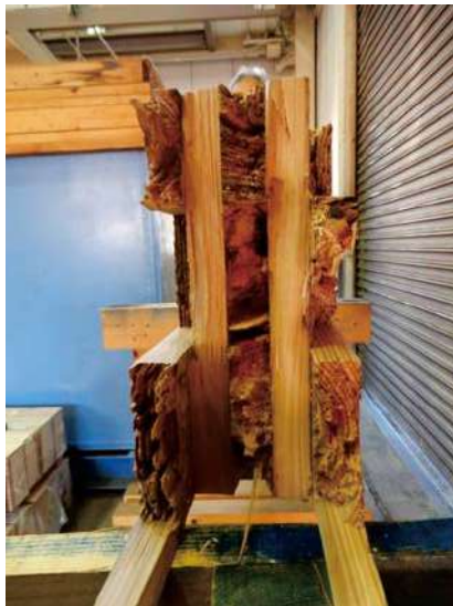
写真 2. 3. 5-9~10 製品処理 AZN の破壊例 (11-T)
