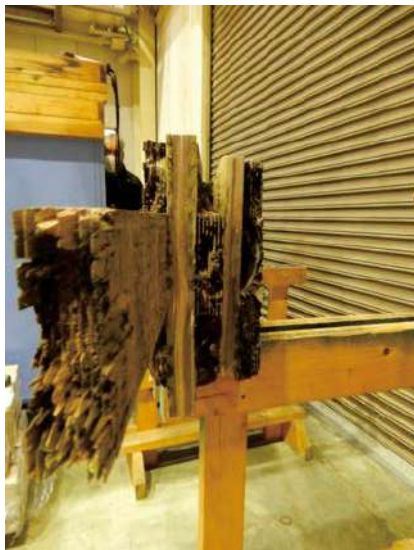
写真 2.3.5-5~6 ラミナ処理 ACQ の破壊例 (4-T)
