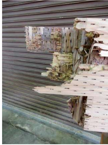
写真 2. 3. 5-7~8 ラミナ処理 AAC の破壊例 (8-T)
