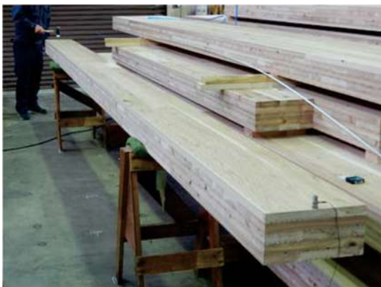
写真 2.3.1-13~14 TGH 法による面外方向の共振周波数測定の様子(左)と得られたピーク(右)
