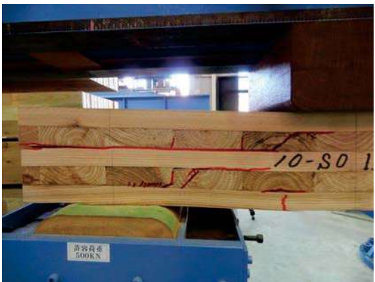
写真 2.3.6-7 製品処理 AZN のせん断破壊例 (10-S0-1)
