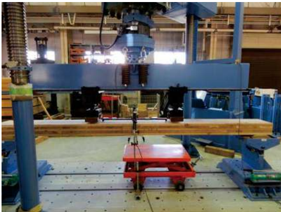
写真 2.3.2-1 曲げ・積層方向試験の様子
