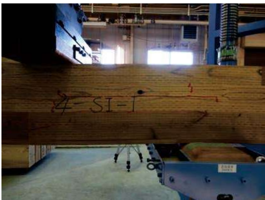
写真 2. 3. 7-7~8 ラミナ処理 ACQ のせん断破壊の例 (4-SI-1)
