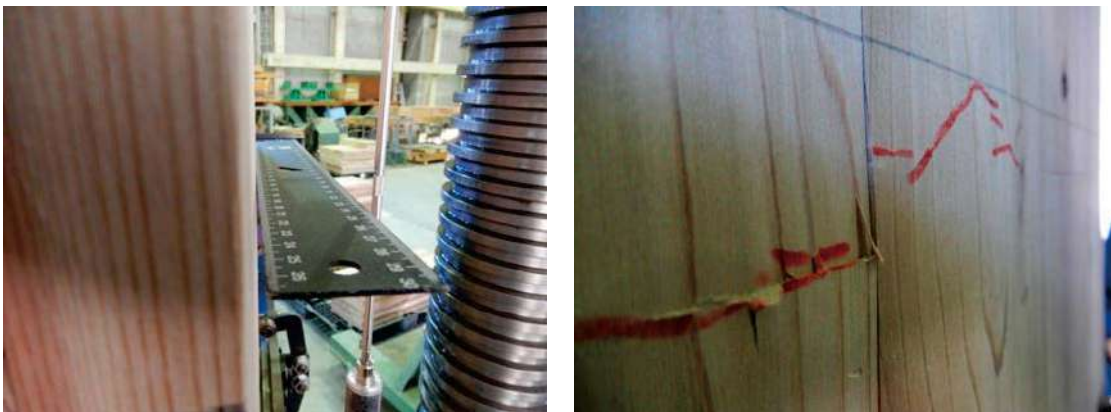
写真 2. 3. 4-11 製品処理 AZN (10-C-2) の試験前の浮き上がり 写真 2. 3. 4-12 製品処理 AZN (12-C-1) の破壊後の浮き上がり
