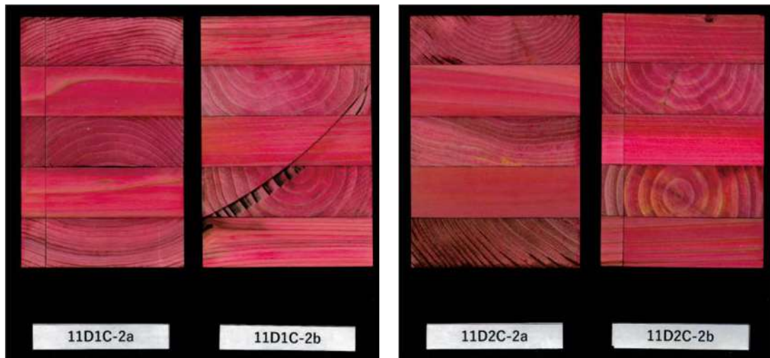
写真 2. 2. 4-3 浸潤度呈色写真 (11D1C 及び 11D2C)
