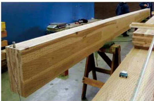
写真 2.3.1-11~12 TGH 法による面内方向の共振周波数測定の様子(左)と得られたピーク(右)
