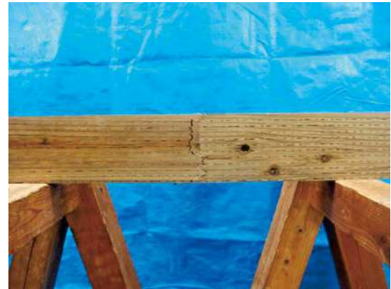
写真 2. 3. 8. 2-6 ACQ 処理 M30 の破壊形態の例
