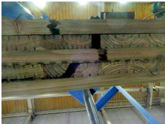
写真 2.3.3-6 ラミナ処理 ACQ の破壊例 (6-BI-1)
