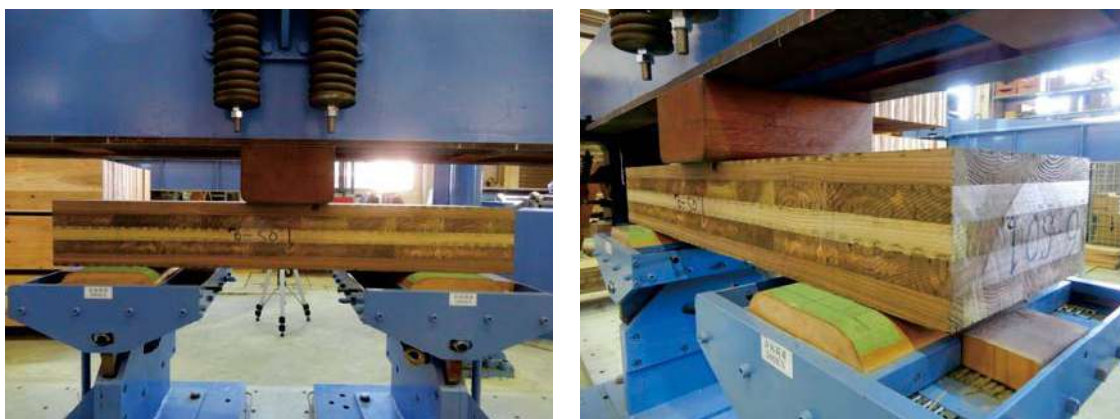
写真 2.3.6-1～2 せん断・積層方向試験の様子
