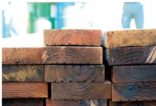
写真2. 2. 1-2 加圧注入後再乾燥前のラミナ (AAC)
