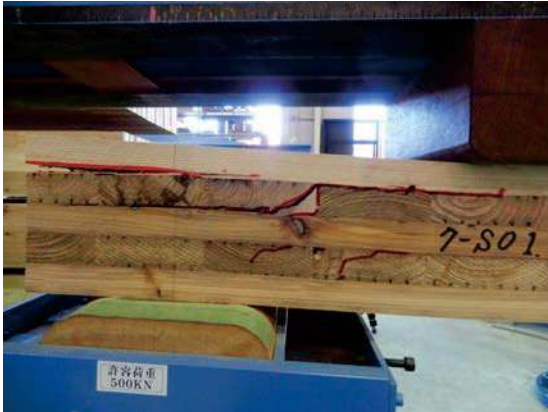
写真 2.3.6-5 ラミナ処理 AAC のせん断破壊例 (7-S0-1)
