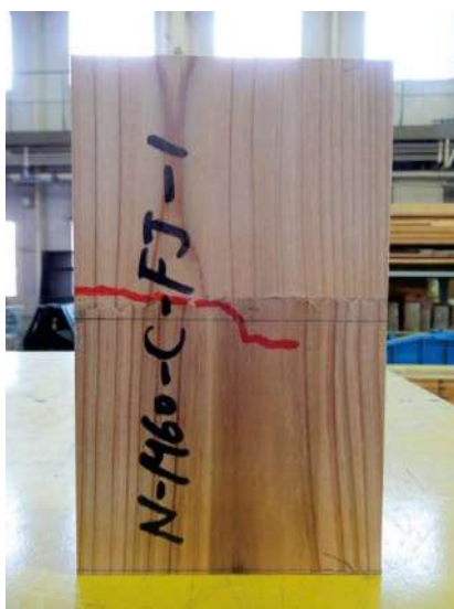
写真 2. 3. 8. 3-3 無処理 M60 の破壊形態の例
