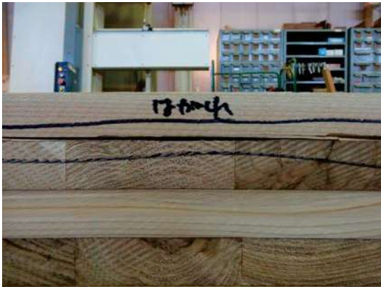
写真 2.3.1-7 接着層のはがれ (12-BI-1) 写真 2.3.1-8 はがれによる浮き上がり 7mm (12-BI-1)
